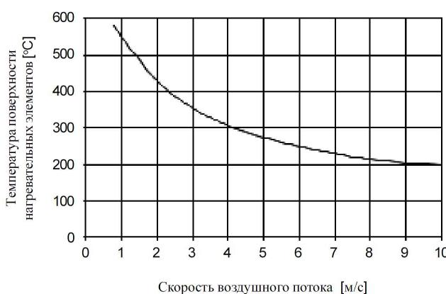
зависит от скорости воздуха в калорифере и поверхностной мощности нагревательных элементов. Мощность нагрева около 3 Вт/см<sup>2</sup>. На диаграмме показано, как температура поверхности нагревательных элементов зависит от скорости воздуха, нагретого до  $20^\circ\text{C}$ .
